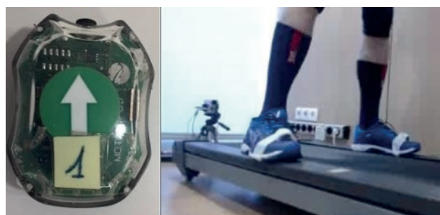
Figura 1. Izquierda: imagen del sensor utilizado en el estudio. Derecha: posición previa del sujeto en la cinta de correr con fijación del sensor al calzado.
