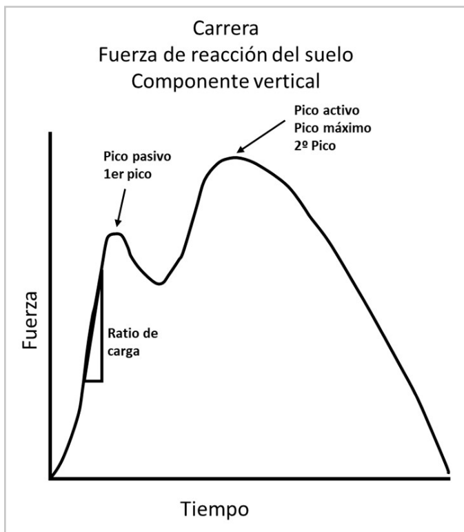
Figura 3. Ilustración de las variables de cinética derivadas de las fuerzas de reacción del suelo verticales.
